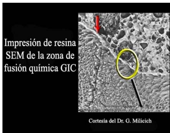
Figura 4: Una técnica de impresión de resina SEM para examinar la zona de fusión química de cemento de ionomero de vidrio (Millicich, 2005).
